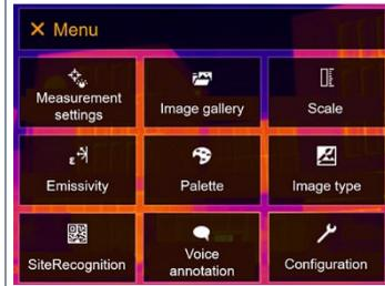
2 Sélectionner Configuration [Configuration] (joystick ou écran tactile).
