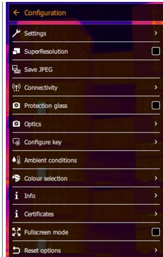
3 Sélectionner SuperResolution [SuperResolution] (joystick ou écran tactile).
