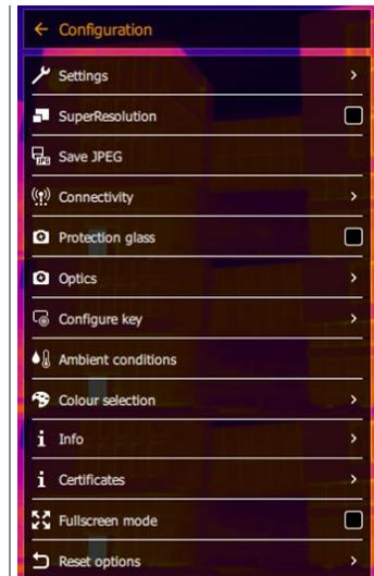
3 Sélectionner Réinitialiser les réglages [Reset options] (joystick ou écran tactile).
